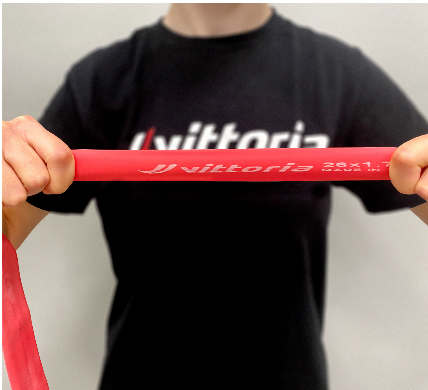
FIGURA 8. Elasticità di una camera d'aria in lattice
